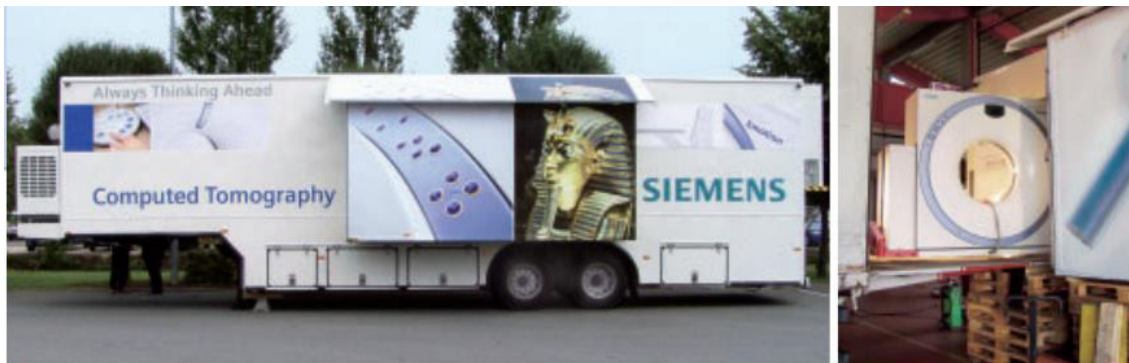
2. ábra. Az egyiptomi „Mummy Project”-hez használt mobil CT-berendezés (Siemens Somatom Emotion 6) [1]
